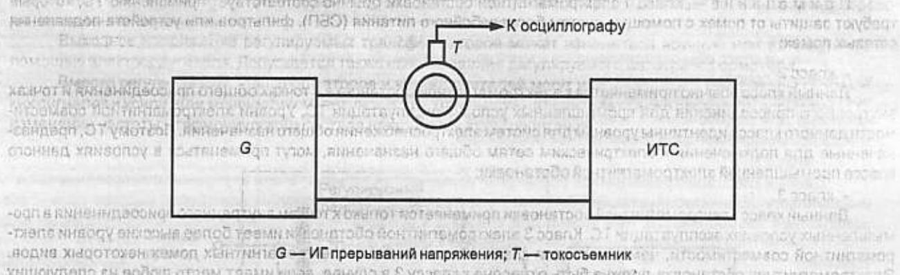
Рисунок А.2 — Схема измерения пикового значения потребляемого тока ИТС
