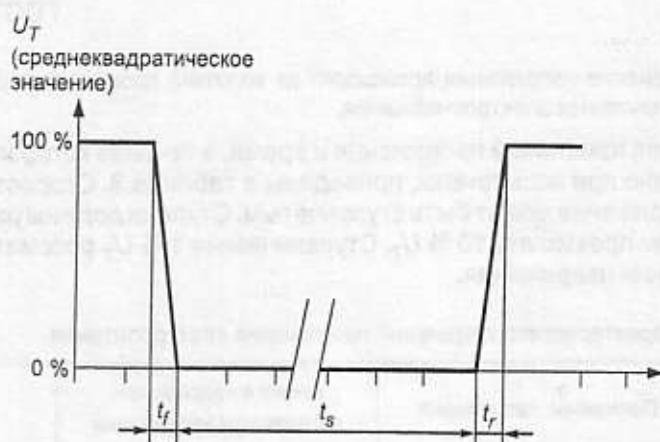
$t_r$  — время нарастания напряжения;  $t_f$  — время понижения напряжения;  $t_s$  — время выдержки на пониженном напряжении
