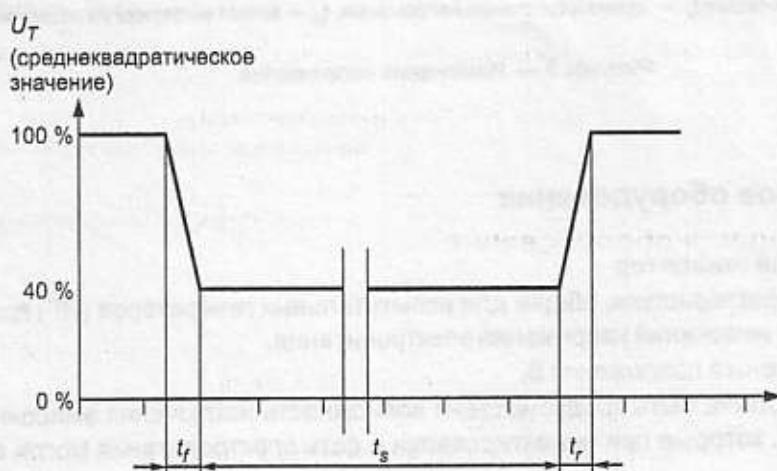
$t_r$  — время нарастания напряжения;  $t_f$  — время понижения напряжения;  $t_s$  — время выдержки на пониженном напряжении
