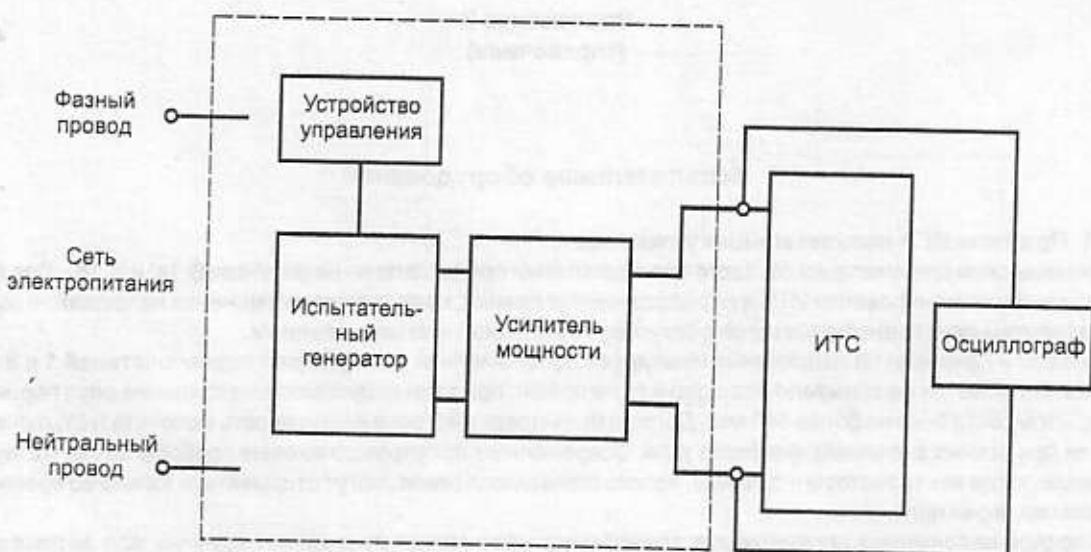
б) Схема испытаний с использованием усилителя мощности
