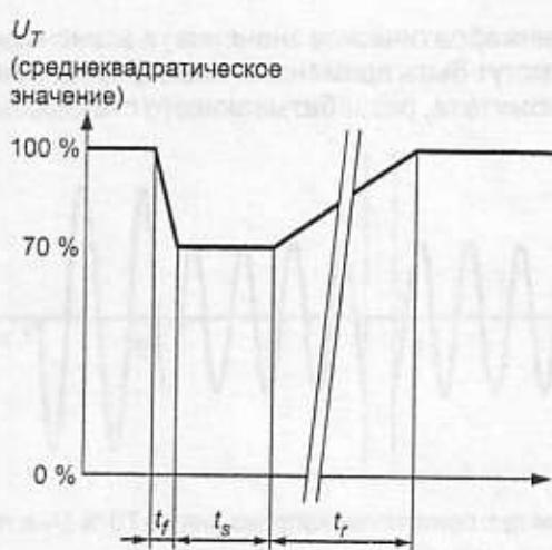
$t_f$  — время понижения напряжения;  $t_r$  — время нарастания напряжения;  $t_s$  — время выдержки на пониженном напряжении
